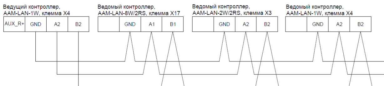
Рисунок 3. Пример подключения ведомых AAM-LAN-1W к ведущему AAM-LAN-1W
